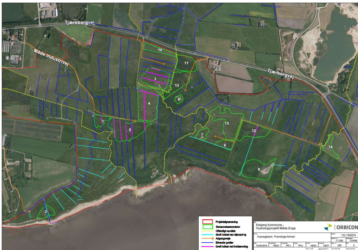
Figur 1.3: Projektforslag for Måde Enge. Rød linje er undersøgelsesområde, gule linjer er større vandløb. De grønne linjer angiver lavtliggende delområder, hvor der foretages afkrabning af jord, lukning af grøfter og anlæg af lave volde til tilbageholdelse af vand fra oversvømmelser fra Vadehavet i Måde Enge. Turkis linjer viser øvrige grøfter, der lukkes. Orange linjer er adgangsveje ved anlægsarbejde.
